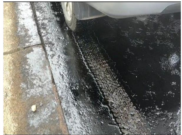
Hình 6. Bề mặt nhũ tương CSS-1 (trái) và nhũ tương thấm bám EcoPrime® (phải) khi có xe đi vào tại thời điểm 4 giờ sau khi tưới.
