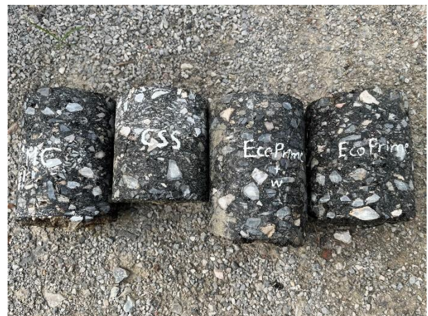
Hình 8. Mẫu khoan đánh giá mức độ dính bám giữa lớp bê tông nhựa và lớp móng CPĐD tại các đoạn thử nghiệm.
