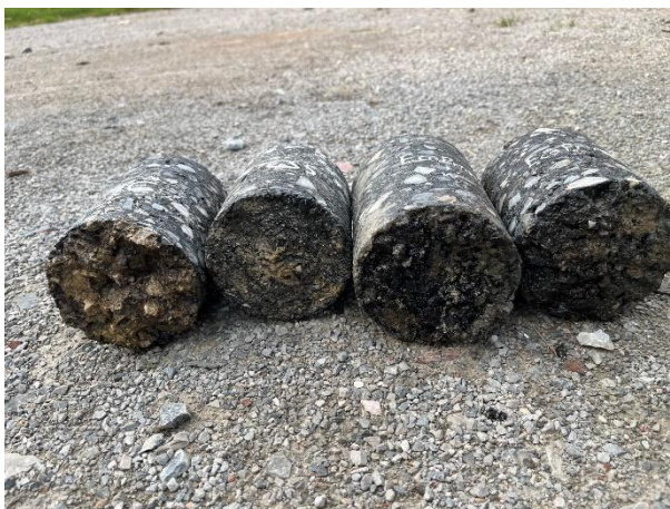
Hình 8. Mẫu khoan đánh giá mức độ dính bám giữa lớp bê tông nhựa và lớp móng CPĐD tại các đoạn thử nghiệm.
