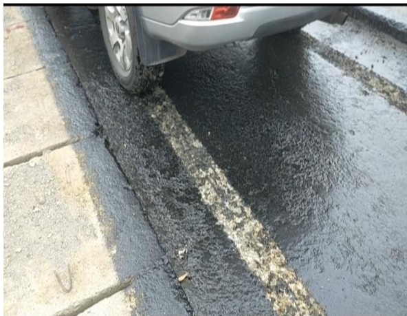
Hình 6. Bề mặt nhũ tương CSS-1 (trái) và nhũ tương thấm bám EcoPrime® (phải) khi có xe đi vào tại thời điểm 4 giờ sau khi tưới.
