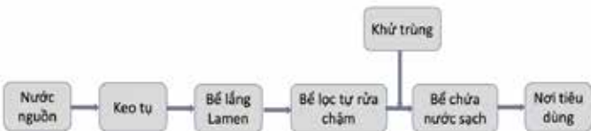
Hình 4. Công nghệ sử dụng bể lắng lamella kết hợp bể lọc tự rửa cho nguồn nước mặt
