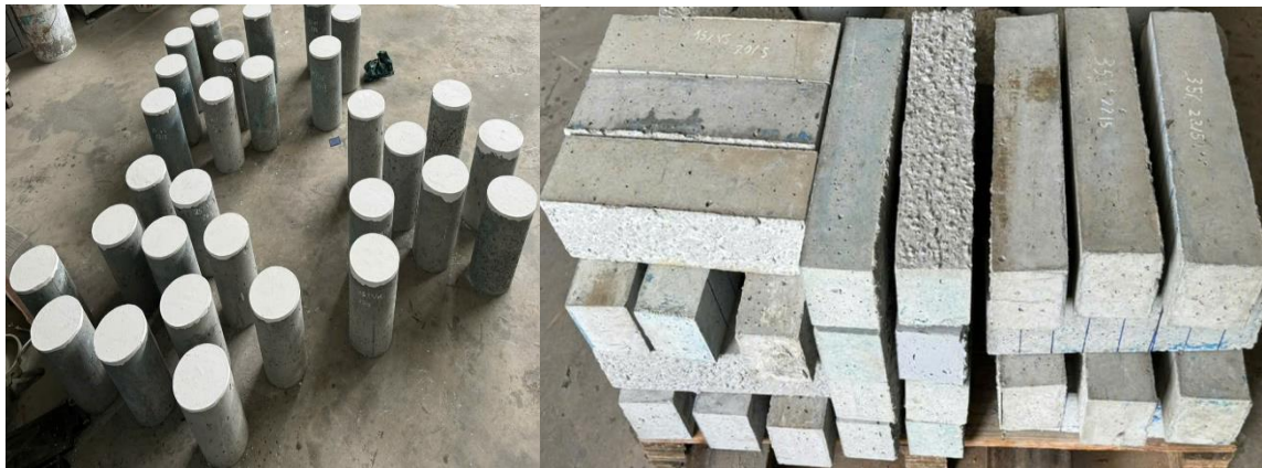
Hình 2. Các mẫu thí nghiệm chịu nén và chịu uốn bê tông sử dụng vỏ hào nghiền.
