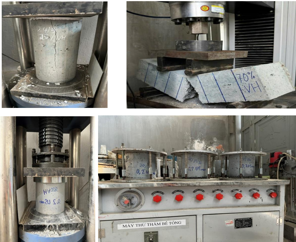
Hình 4. Thí nghiệm xác định cường độ chịu nén, chịu uốn, độ thấm nước của bê tông sử dụng vỏ hào nghiền (Các mẫu thấm nước có hàm lượng vỏ hào khác nhau được nén trước với các cấp ứng suất nén khác nhau)
