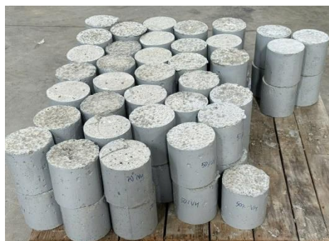
Hình 3. Các mẫu thí nghiệm đo thấm nước của bê tông vỏ hào nghiền.
