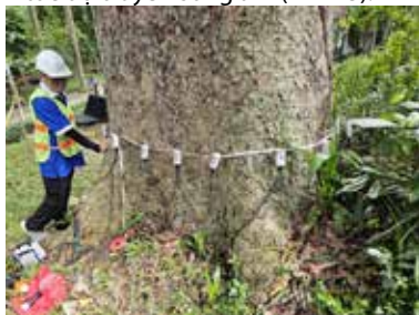
Hình 3. Nhóm nghiên cứu kiểm tra tình trạng gỗ ở phần thân gốc bằng vòng cảm biến sóng âm được gắn trên cây
