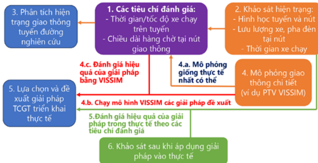
Hình 1. Quy trình đề xuất phương án tổ chức giao thông phân làn trên đường đô thị
