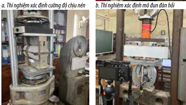
a. Thí nghiệm xác định cường độ chịu nén b. Thí nghiệm xác định mô đun đàn hồi c. Thí nghiệm xác định cường độ chịu kéo khi ép chèn d. Thí nghiệm xác định cường độ chịu kéo khi uốn
