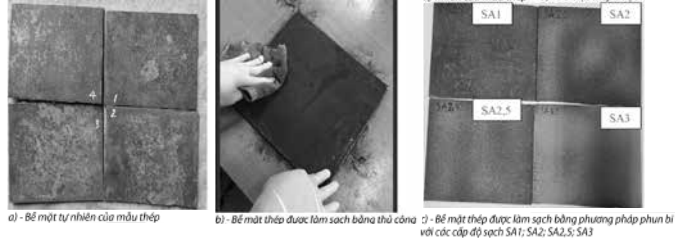
Hình 5. Bề mặt mẫu thép với các cấp độ sạch thí nghiệm
