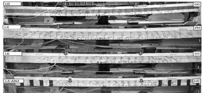
Hình 4. Hình thái vết nứt và kiểu phá hoại của các dầm thí nghiệm Nhóm L
